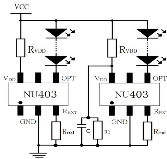
說明：DC power 調光應用 ( PWM ) 中雙色溫調節。其原理是通過上圖中的 C、R1 實現的，通過改變容量大小可以改變延時比例。
